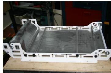
Sistema fissaggio pezzi in lavorazione
