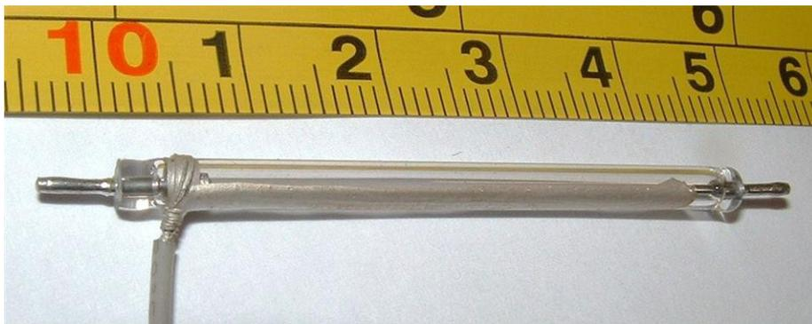
请注意覆盖触发线并向下延伸到灯的灰色导电涂料。小心不要对该螺纹施加太大压力，因为油漆可能会破裂。在这种情况下，它会开始间歇性地发出火花，并且闪光会变得不稳定。
