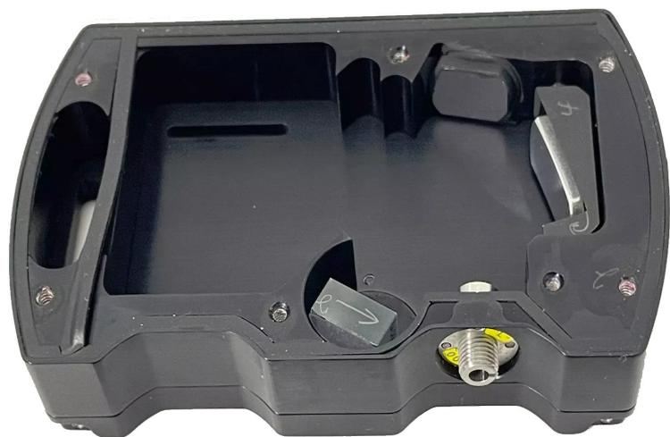
I banchi ottici degli spettrometri molto costosi usano reticoli a riflessione e specchi collimatori. Questi banchi ottengono un aumento di luminosità di due o tre volte, grazie al reticolo a riflessione e un aumento di altre cinque o dieci volte, grazie allo specchio collimatore.
