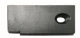
为了完全消除反射,孔应该尽可能窄和低。由于透镜相对于入口狭缝的高度可能因一种结构而异,因此找到其理想尺寸的最佳方法是将强光放在狭缝后面并用黑色纸板测试,您可以将四个壁拉紧多远洞的。
